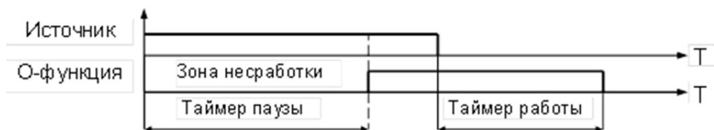
Рис. 3.18 - Диаграмма работы определяемой функции, тип функции – обратный
