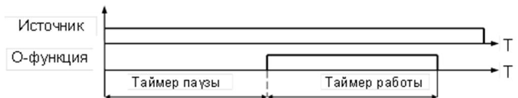
Рис. 3.17 - Диаграмма работы определяемой функции, тип функции – прямой
