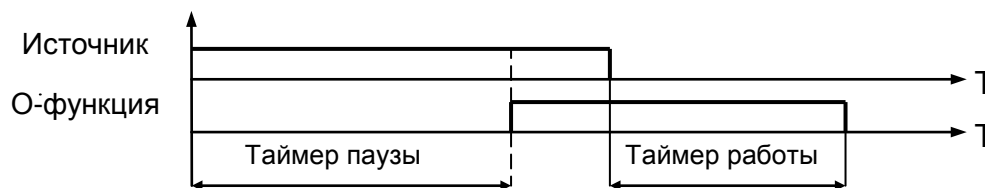
Рис. 19 Диаграмма работы определяемой функции, тип функции - обратная
