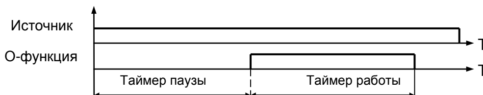
Рис. 18 Диаграмма работы определяемой функции, тип функции – прямая
