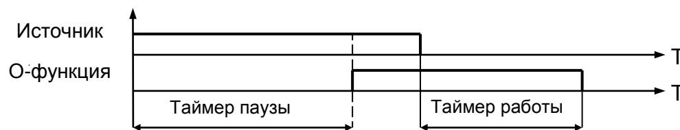
Рис. 1.7.15.2 Диаграмма работы определяемой функции, тип функции – обратная
