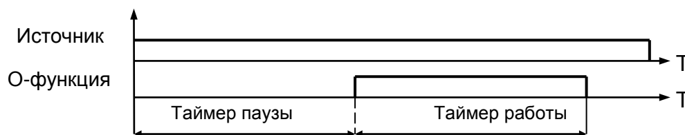
Рис. 1.7.15.1 Диаграмма работы определяемой функции, тип функции – прямая
