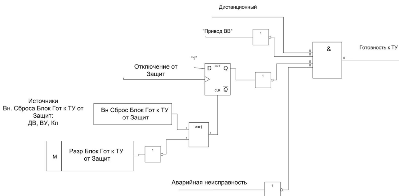
Рис. 1.7.14 Функциональная схема блока готовности к ТУ
