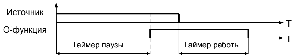
Рис. 1.4.15.2 Диаграмма работы определяемой функции, тип функции – обратная
