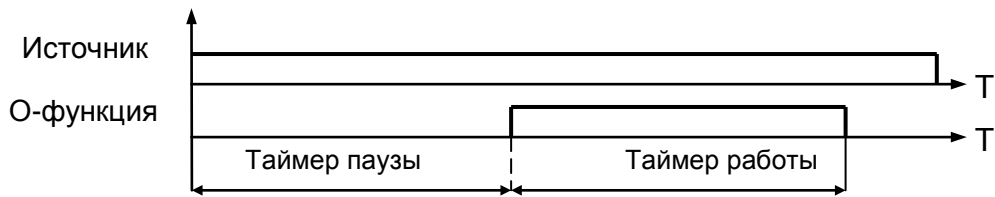
Рис. 1.4.15.1 Диаграмма работы определяемой функции, тип функции – прямая
