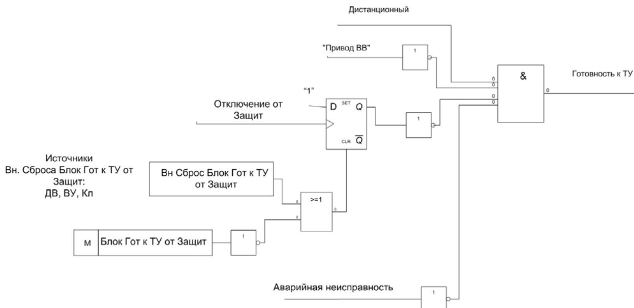
Рис. 1.4.14 Функциональная схема блока готовности к ТУ
