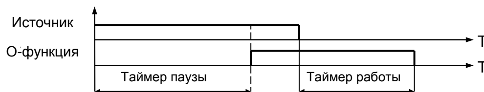
Рис. 1.7.17.2 Диаграмма работы определяемой функции, тип функции – обратная
