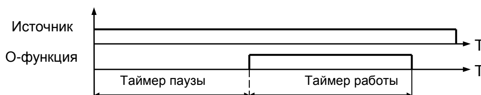
Рис. 1.7.17.1 Диаграмма работы определяемой функции, тип функции – прямая
